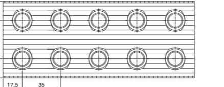
con tubi di rame diam 12 mm, nella geometria quadrata 35.00 X 35.00, con alette corrugate, ideale per la realizzazione di evaporatori per la refrigerazione di ogni tipo.
