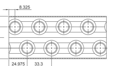
con tubi di rame diam 12 mm, nella geometria sfalsata 33.3 x 28.8 con alette corrugate, impiegata nel riscaldamento, condizionamento e nella refrigerazione dell'aria (batterie ad acqua e vapore, condensatori ed evaporatori) di media ed alta potenzialità.
