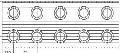
con tubi di rame diam 10 mm, nella geometria quadrata 35.00 X 35.00, con alette corrugate, ideale per la realizzazione di evaporatori per la refrigerazione di ogni tipo.
