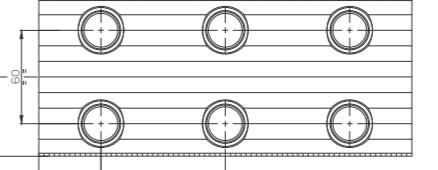
Con tubi di rame diam 16 mm, nella geometria quadrata 60.00 X 60.00 con alette corrugate. Ideale per la realizzazione di evaporatori per la refrigerazione di ogni tipo.
