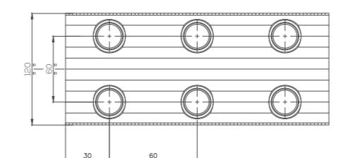
con tubi di rame diam 16 mm, nella geometria sfalsata 60.00 X 30.00 con alette corrugate, impiegata nel riscaldamento, condizionamento e nella refrigerazione dell'aria (batterie ad acqua e vapore, condensatori ed evaporatori) di media ed alta potenzialità.
