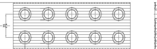
con tubi di rame diam 10 mm, nella geometria quadrata 35.00 X 35.00, con alette corrugate: ideale per la realizzazione di evaporatori per la refrigerazione di ogni tipo.
