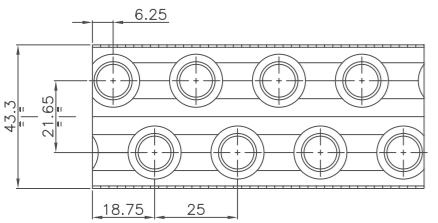
con tubi di rame da 9.52 mm (3/8"), nella geometria sfalsata 25.00 X 21.65, con alette corrugate: impieghi nel condizionamento e nella refrigerazione dell'aria (batterie ad acqua, condensatori ed evaporatori ventilati) di piccola e media potenzialità.
