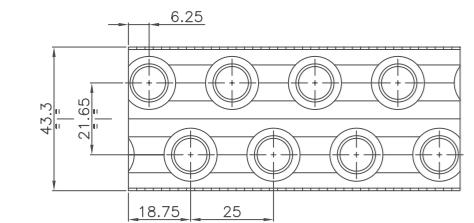
con tubi di rame da 7.94 mm (5/16"), nella geometria sfalsata 25.00 X 21.65, con alette corrugate: impieghi nel condizionamento e nella refrigerazione dell'aria (batterie ad acqua, condensatori ed evaporatori ventilati) di piccola e media potenzialità.
